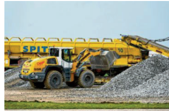
Hier am Gewerbegebiet wird der Schotter auf die Waggons mit den Fließbändern verladen.
