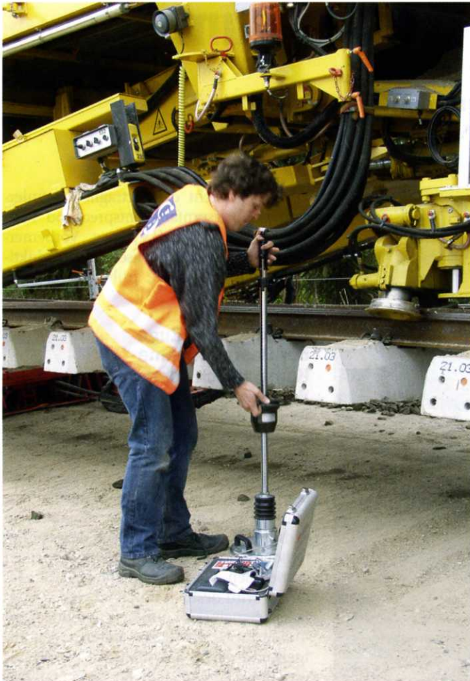
Abb. 2: Durchführung einer Tragfähigkeitsmessung mit dem Leichten Fallgewichtgerät (LFG)
