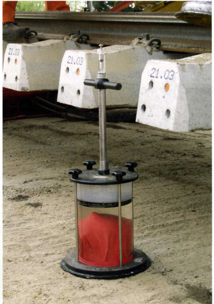
Abb. 3: Bodendensitometer zur direkten Dichtekontrolle des eingebauten Korngemisches
